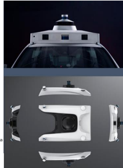
Figura 41 Esempio di configurazione dei sensori e integrazione nel veicolo per robo-taxi di Pony.ai [137]
